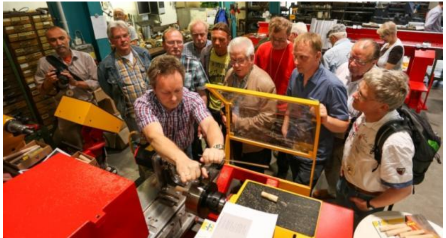
Wema-Konstrukteur Eugen Müller (vorn links) erklärt den Gästen des Drechseltages die Vorteile eines Drechselautomaten. Dieser kann auch gerade Kanten drechseln.
